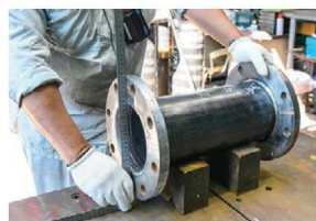
原管受入検査
